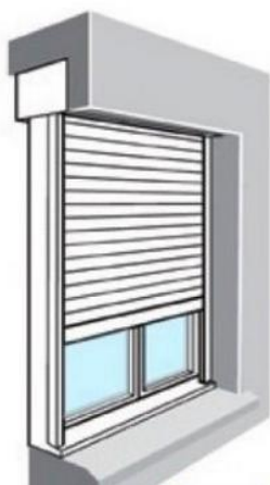
Intégration en façade
