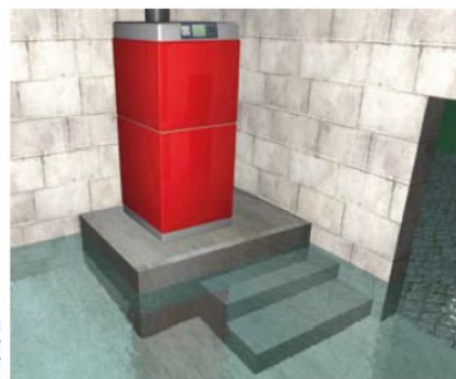
Protection d'un équipement de chauffage par surélévation.
