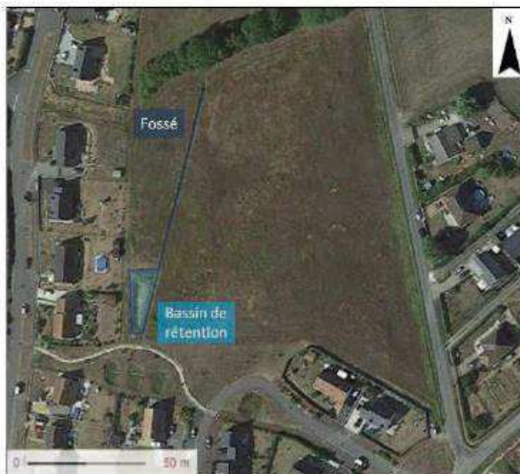
Figure 7 : Emplacement du réseau d'eaux pluviales existant (source : Google Earth et annotations BURGEAP)
