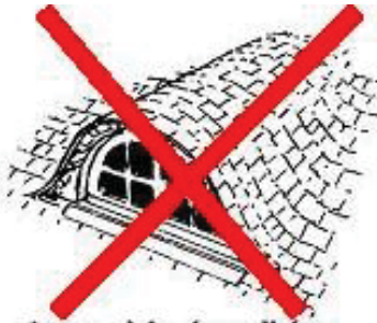
lucarne à jouées galbées (couverture ardoise ou chaume)
