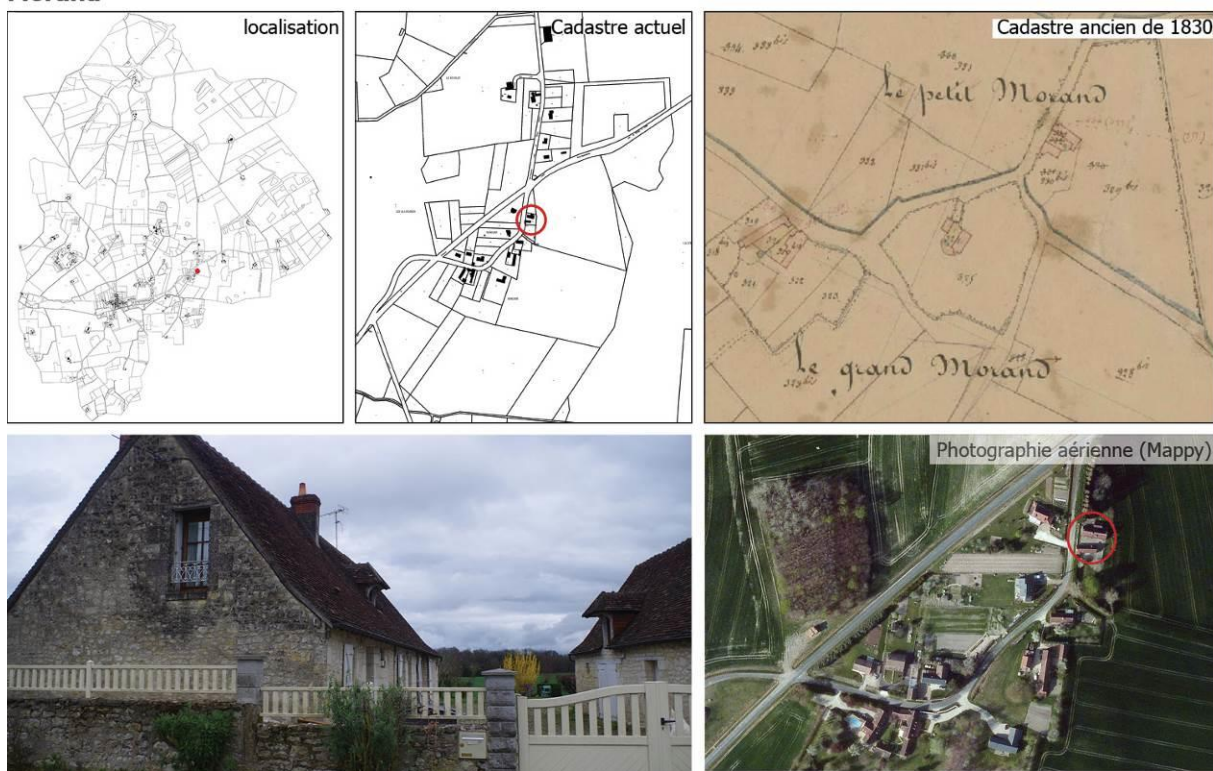
Deux longères parallèles avec faitage orienté Ouest-Est. Lucarnes capucines remarquables. Lucarne capucine et meunière pour la longère Sud.
