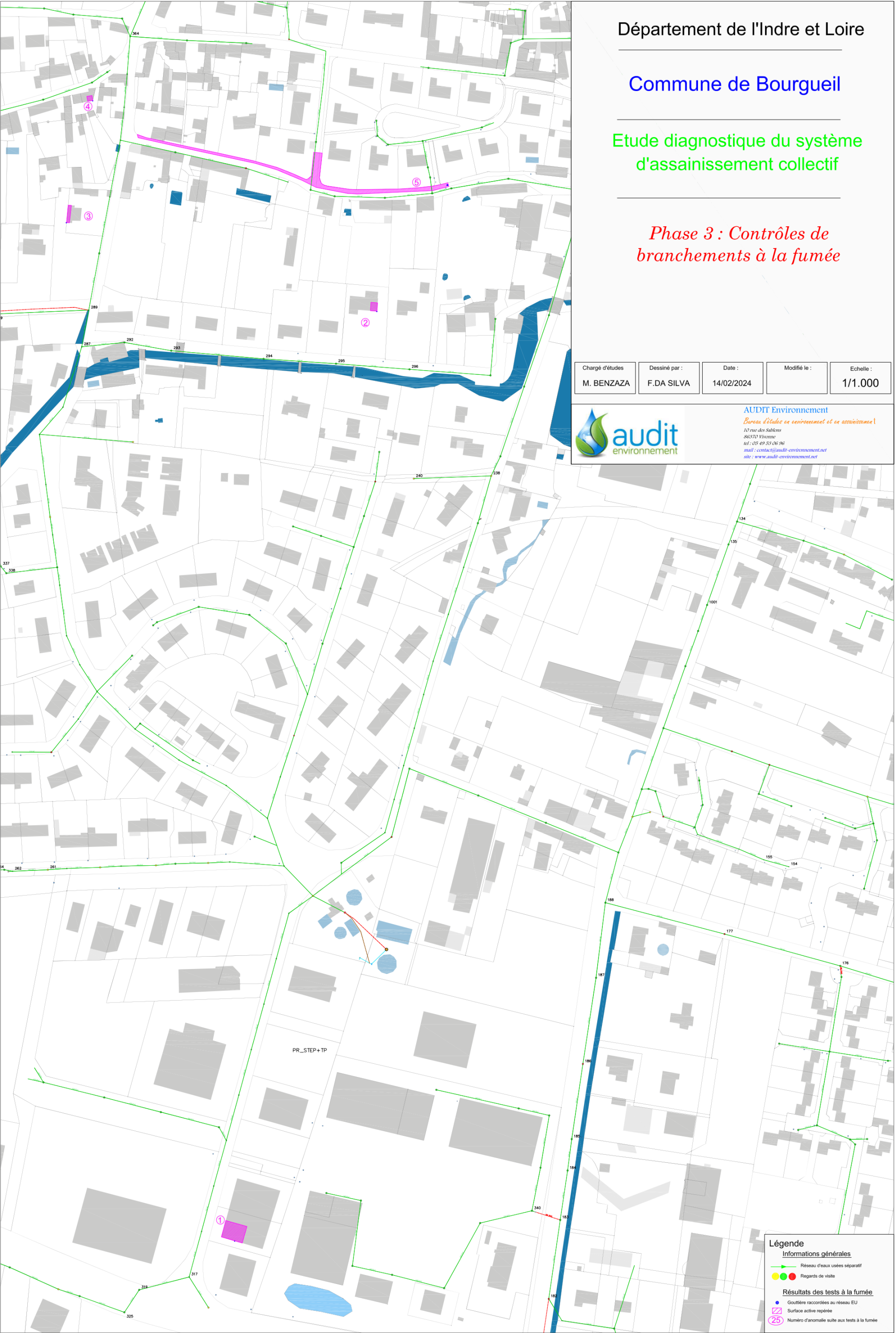
Figure 20 : Plan des anomalies recensées aux tests à la fumée
