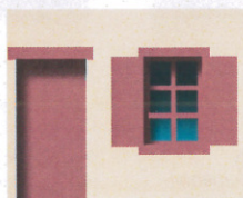
Maison rurale : porte, fenêtre, volets et encadrement/linteau et appui bois identiques.
