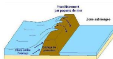
Illustration 9: franchissement par paquet de mer
