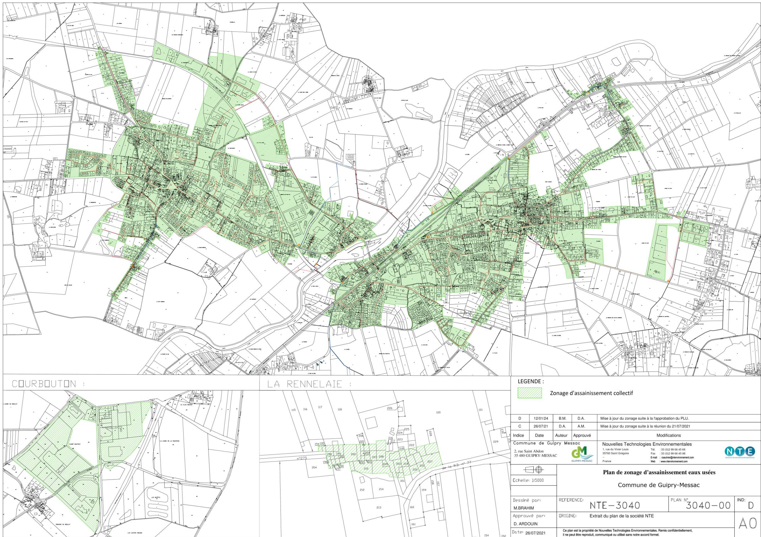
Figure 45 - Plan du zonage d'assainissement collectif proposé pour la commune de Guipry-Messac
