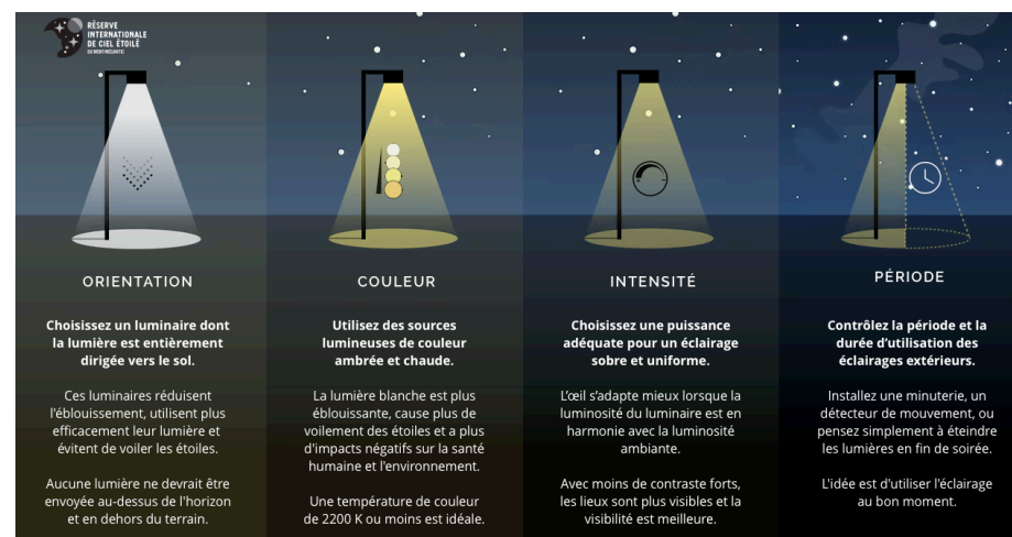
Figure 9. Combinaison de 4 principes lumineux pour un éclairage respectueux du ciel étoilé et de la nuit
