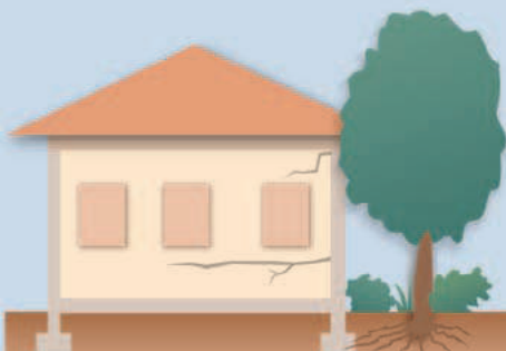
Désordres partiels dûs à l'action localisée d'un arbre
