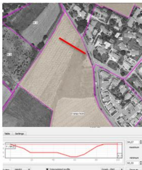
Illustration 23 : Profil en travers au droit du trait rouge
