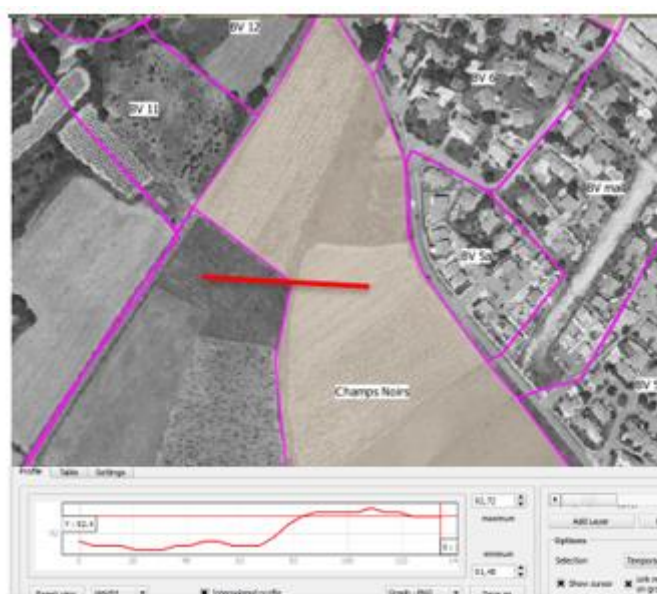
Illustration 24 : Profil en travers au droit du trait rouge
