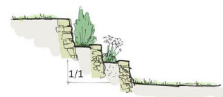
Coupes de principe de restanques Source : « Projet Pics Studio – Etude environnementale : volet paysager », ARCADI, Juillet 2022
