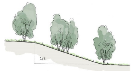
Coupe de principe d'un talus végétalisé Source : « Projet Pics Studio – Etude environnementale : volet paysager », ARCADI, Juillet 2022
