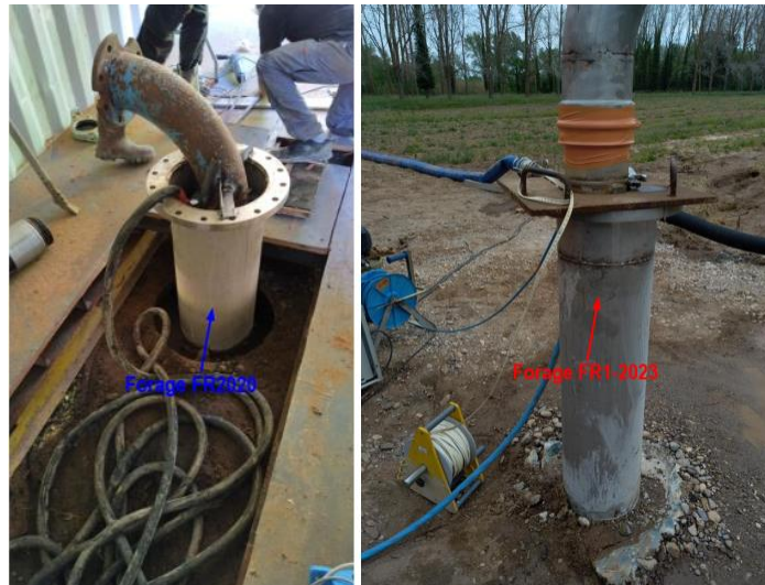
Figure 2 - Forage FR 2020 et FR1-2023 lors des pompages d'essai
