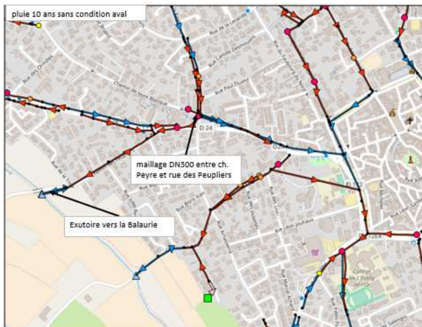
Figure 86: Insuffisance secteur chemin de Peyre Mauguio
