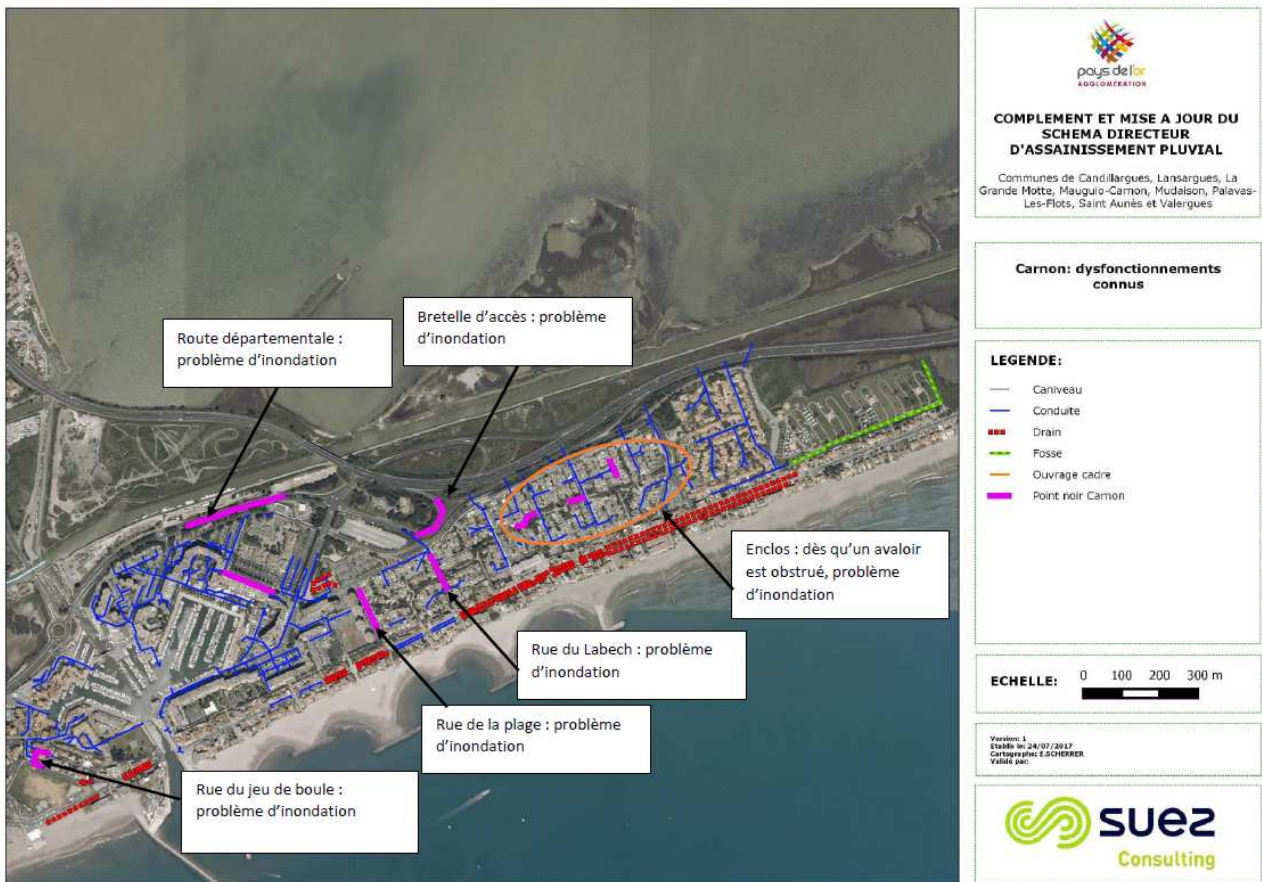
Figure 21: localisation des points noirs sur la commune de Carnon (source: réunion de démarrage avec la commune)
