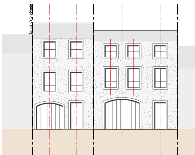
Schéma illustratif : Principe d'alignement des axes des baies et ouvertures en façade
