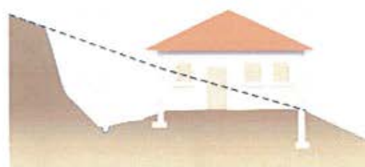
Plate-forme en déblais
