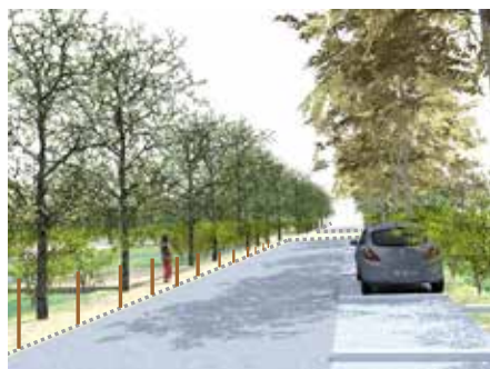
Profil 2 – Voirie secondaire – Largeur 9 m
