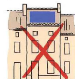
Implantations interdites : implantations anarchiques et/ou en sur-épaisseur décollée de la toiture
