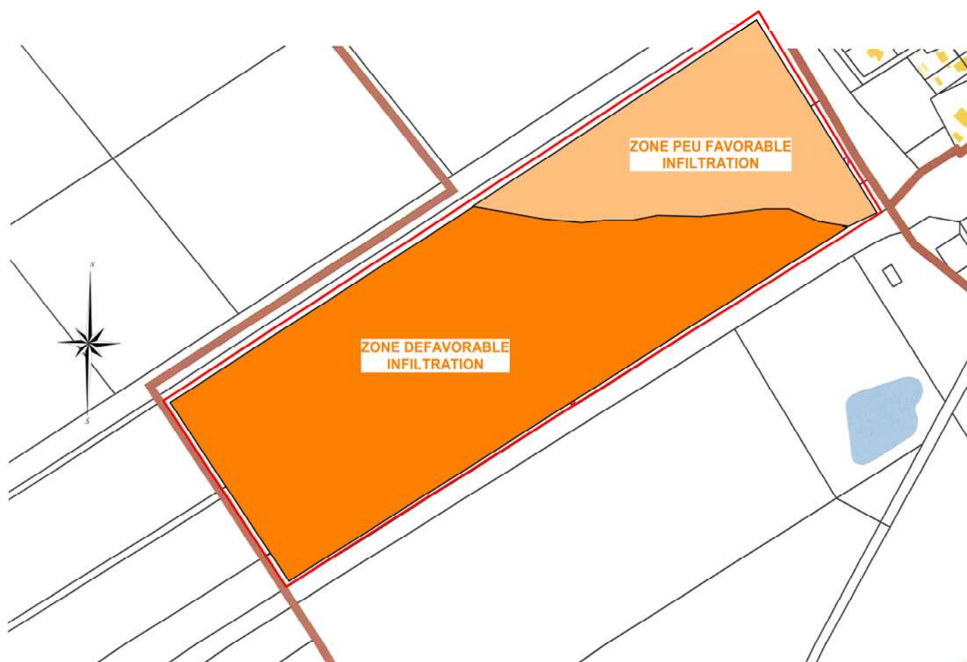
Figure 9 : synthèse des conditions d'infiltration
