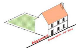
Construction à l'alignement
