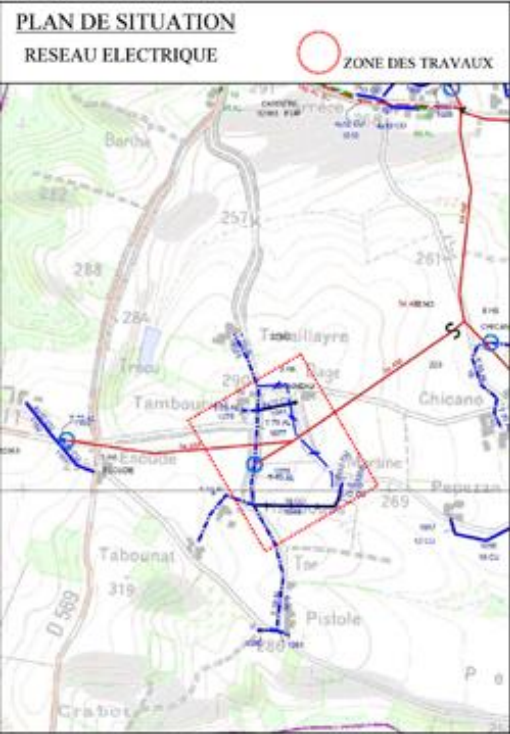
Plan de recollement du réseau ERDF fourni par le SDEG (Syndicat d'électrification du GERS) sur le secteur du hameau de Martine (ci-contre et page suivante en détail)
