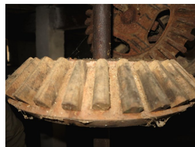
Fig. 27 - Mécanisme permettant de produire de l'électricité : détail d'une roue à dents en bois.
