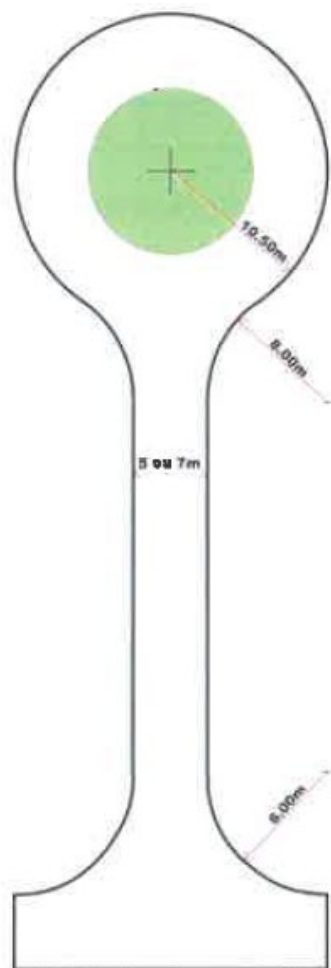
Figure 1 - Principe de retournement de type « raquette »
