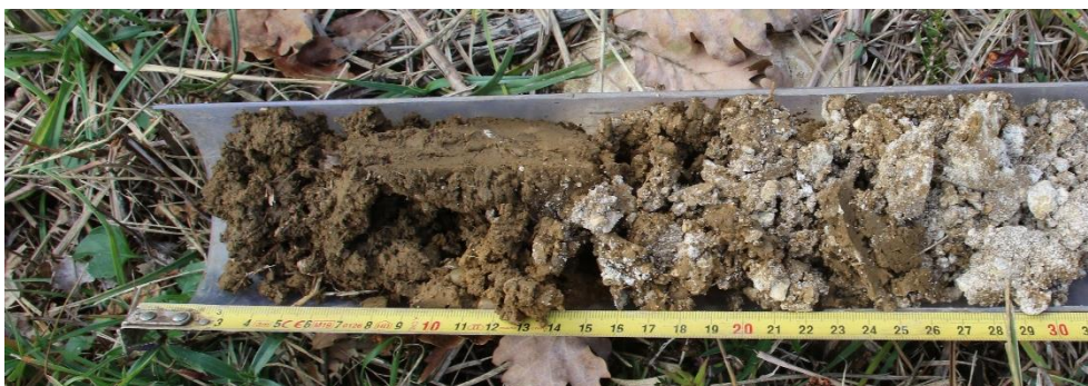
Sol avec horizon calcaire rendant impossible la suite du sondage à la tarière à main (sondage S15)
