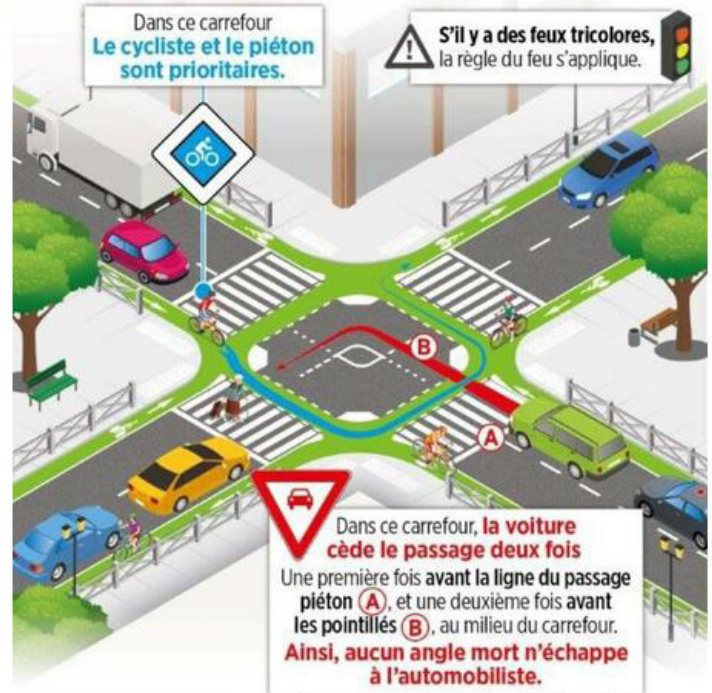
Sécurisation par mise en place d'un « carrefour hollandais »
