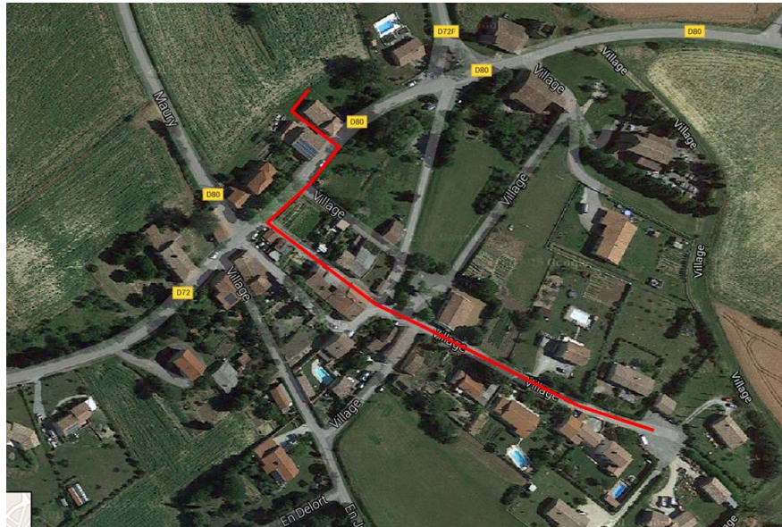
Fig. 13. Canalisation pluviale présente dans le village
