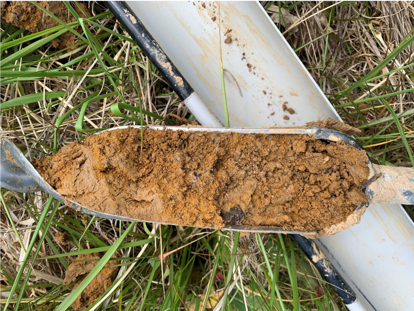
Figure 11 : Photographie d'un sol très argileux susceptible de retenir l'eau (photographie prise hors zone de projet)
