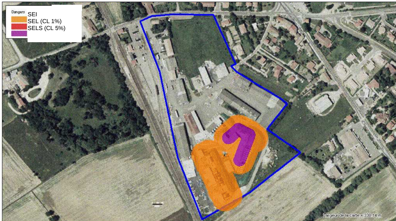
PPRT de Escalquens (GACHES CHIMIE) Enveloppes des effets toxiques à cinétique rapide potentiels
