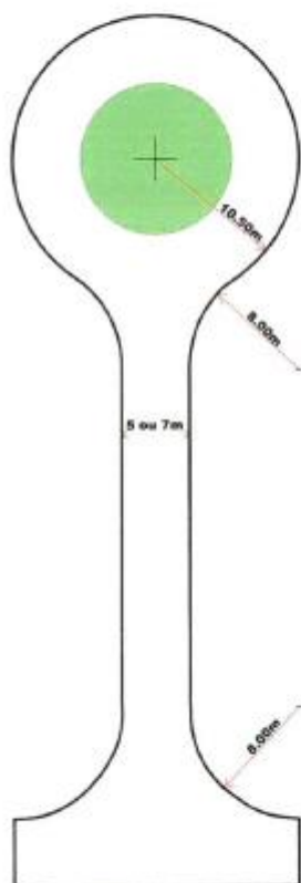
Figure 1 - Principe de retournement de type « raquette »
