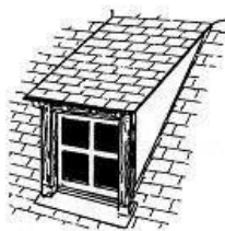
lucarne rampante ou en chien couché
