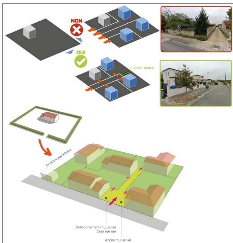
Exemple de principe d'optimisation des accès et du stationnement d'une opération de division foncière
