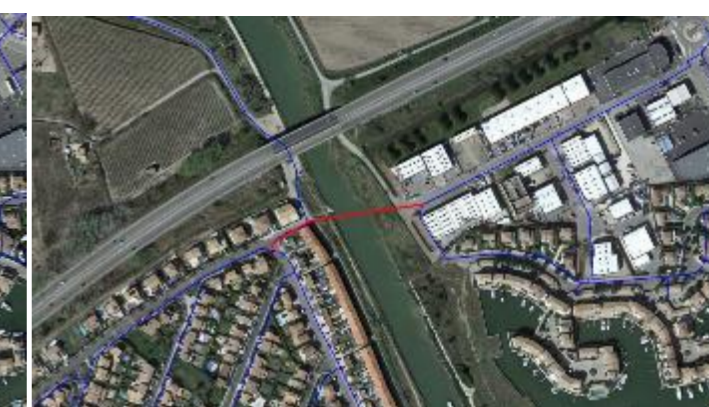
Tracé SC2b par forage dirigé sous le canal
