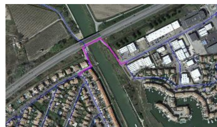
Tracé SC2a par encorbellement sur le pont du canal
