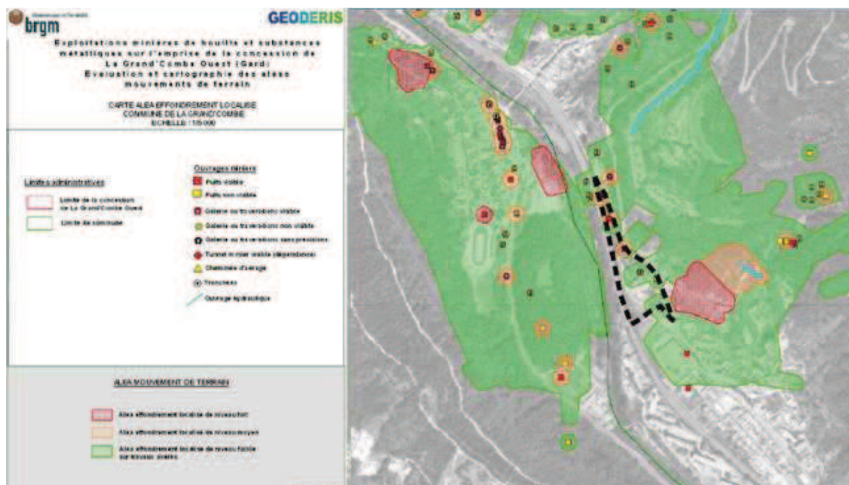
Risque effondrement (localisé) (Source : Etude Géodéris, 8 septembre 2011)
