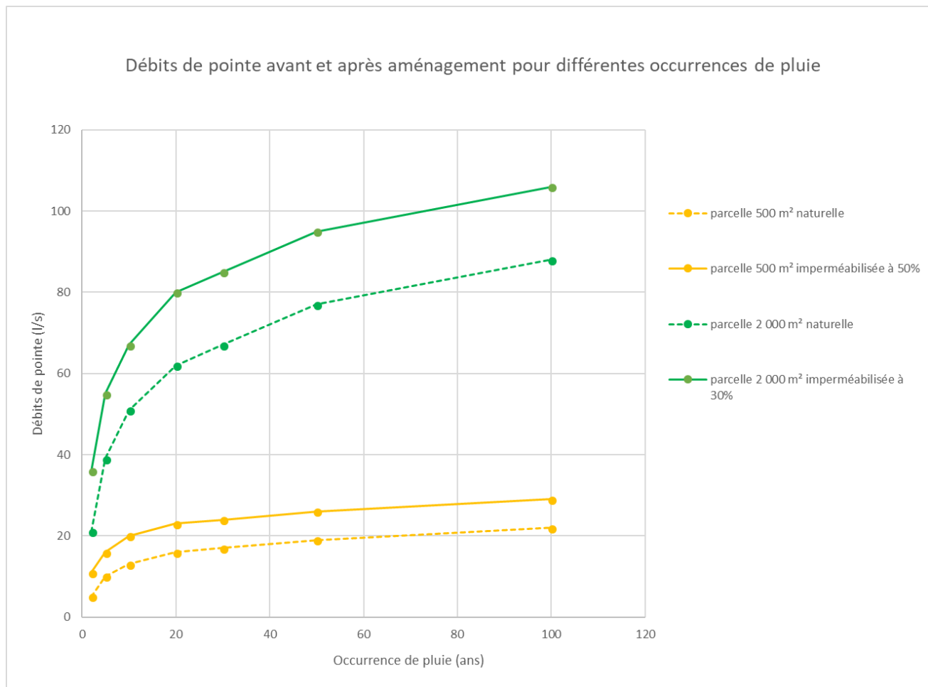
Illustration 9 : Augmentation des débits de pointe engendrée par l'imperméabilisation pour différentes occurrences
