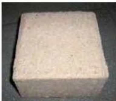
Pavés en béton poreux
