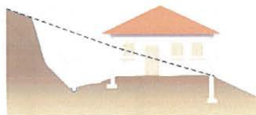
Plate-forme en déblais
