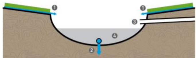
Noue de rétention
