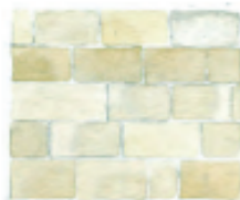
Appareillage régulier en pierre de taille, montés à sec ou à joints fins.
