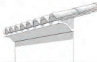
Dépassée de toiture sur corniche à «l'italienne»
