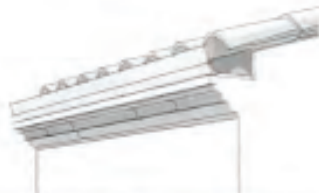
Dépassée sur corniche en pierre taillées avec chéneau ou zinc
