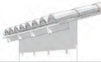
Dépassée de toiture sur abouts de chevrons
