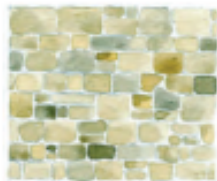
Appareillage régulier en moellons équarris, montés au mortier de chaux.
