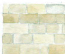
Appareillage régulier en pierre de taille, montées à sec ou à joints fins.
