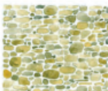
Appareillage de moellons de toute tailles non assisés, équarris ou non et montés au mortier de chaux et sable.
