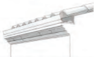
Dépassée sur corniche en pierre taillées avec chéneau en zinc
