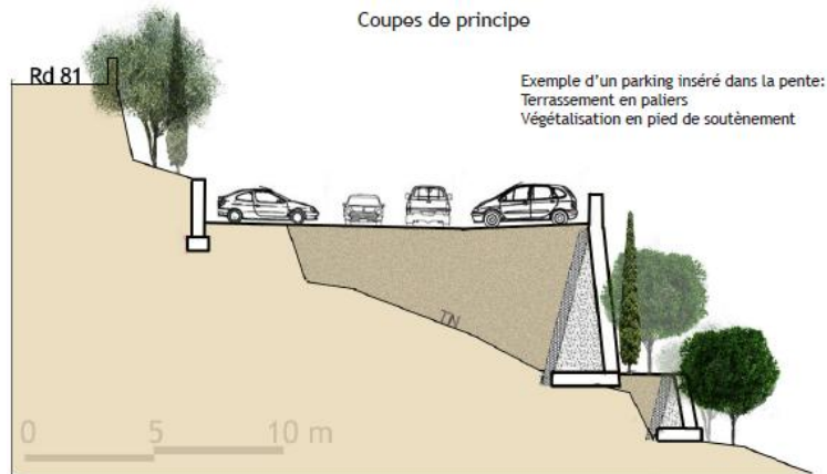
Exemple de traitement des murs
