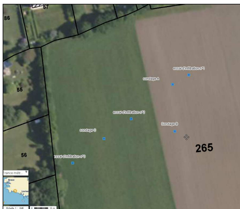
Figure 8 : Localisation des sondages et des essais d'infiltration
