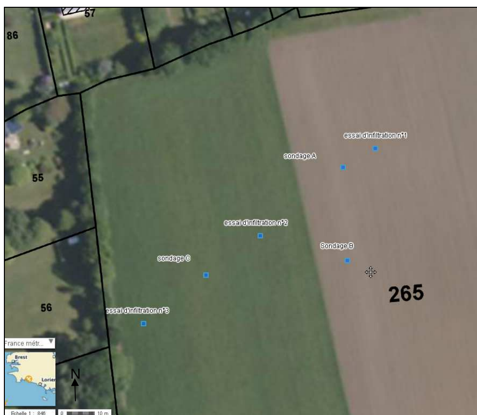
Figure 13 : Localisation des sondages et des essais d'infiltration
