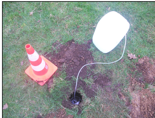
Photo 5 : Essai d'infiltration Porchet (Laboce)
