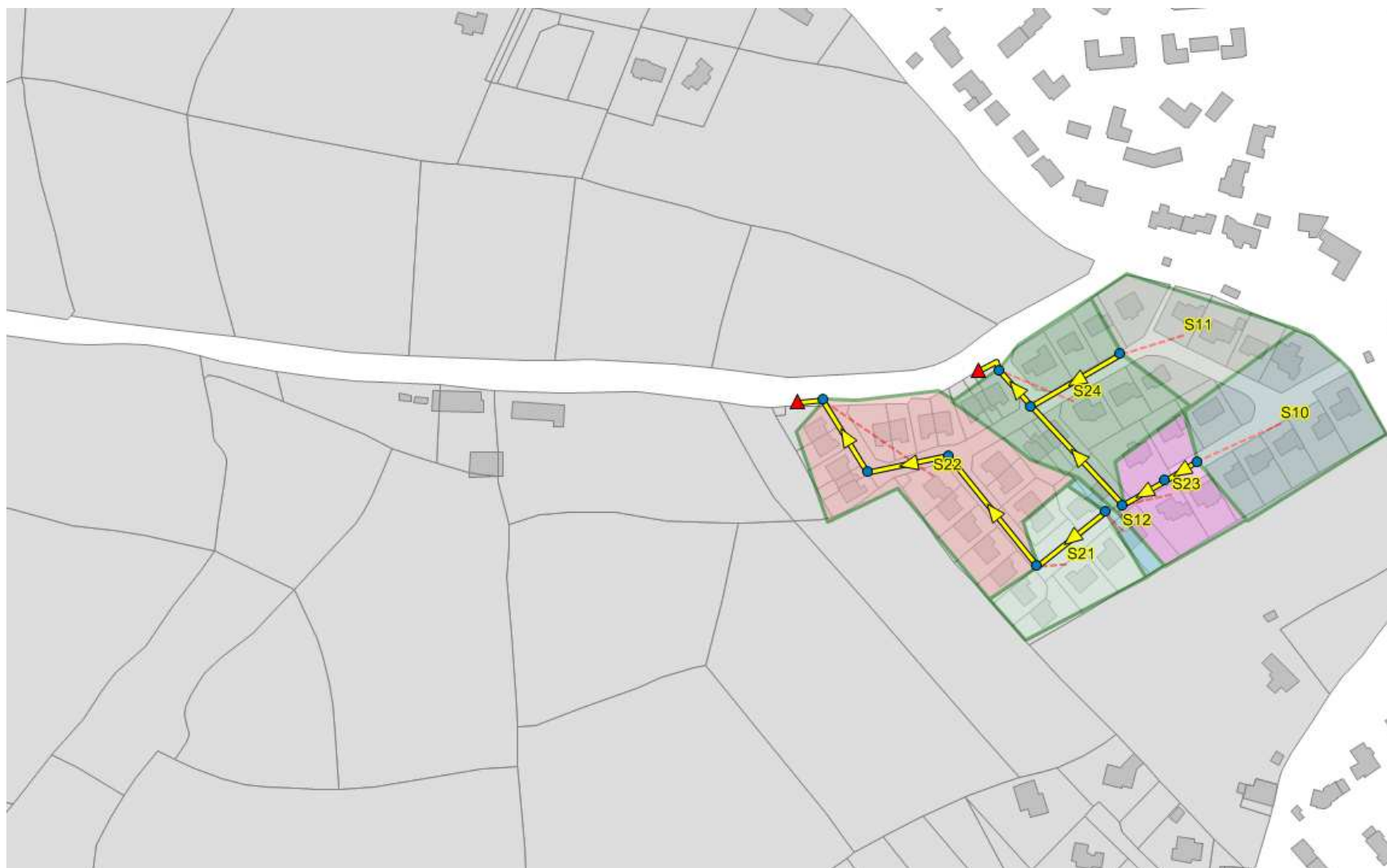
Illustration 5 : Vue en plan des réseaux modélisés lotissement rue Kernévez Vian
