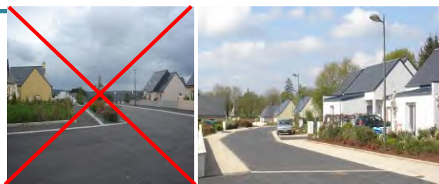
Exemple d'utilisation abusive de l'enrobé et d'une rue de taille adaptée desservant plusieurs lots, avec une utilisation mesurée de l'enrobé
