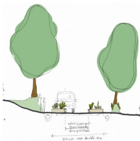
Exemple de profil pour la voirie principale
