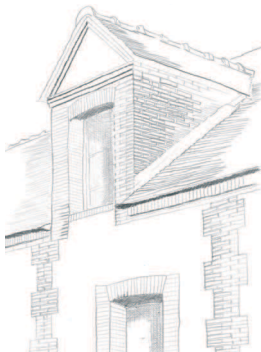
Lucarne, encadrement de baie et chaînes harpées en brique appareillée à Brezolles.
