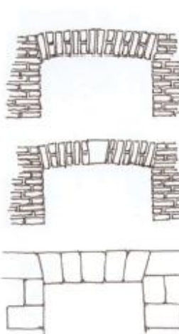
Exemples d'encadrements de baies en brique et en pierre de taille.
