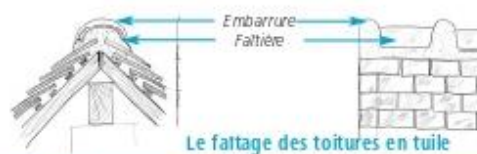
Le faitage des toitures en tuile
