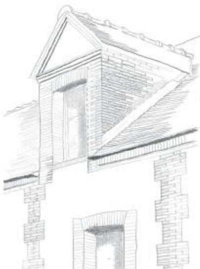
Lucarne, encadrement de baie et chaînes harpées en brique appareillée à Brezilles.
