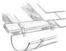
Gouttière pendante posée en débord et sous l'égoût de toit.
