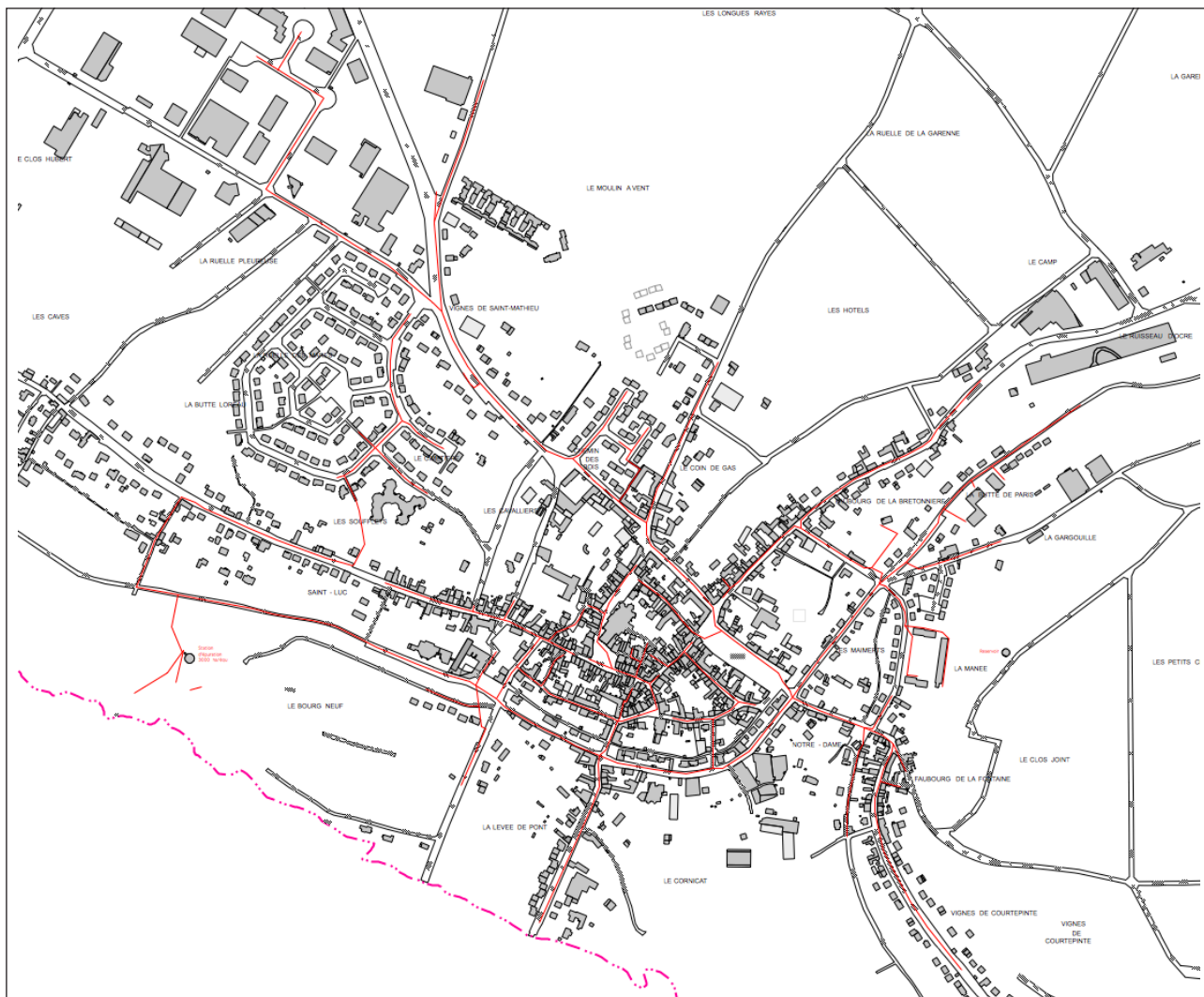
Réseau de collecte des eaux usées
