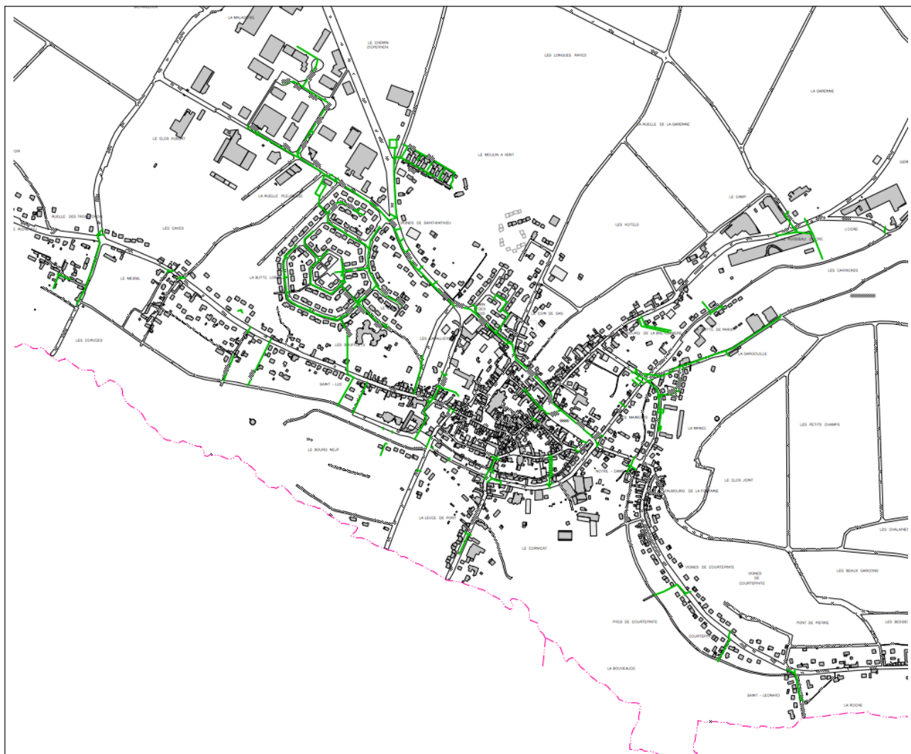
Réseau de collecte des eaux pluviales
