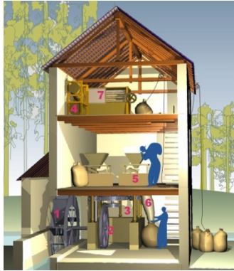
Schéma d'un moulin à l'anglaise, dans les années 1830 © Service régional de l'inventaire de Poitou-Charentes / Zoé Lambert, 2007
