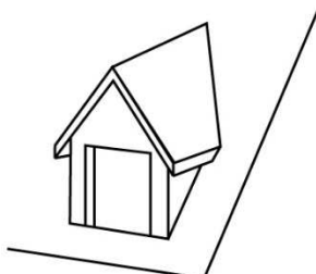
Illustr. 4 - Lucarne en bâtière
