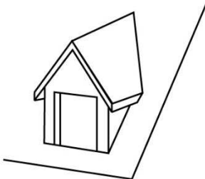
Illustr. 4 - Lucarne en bâtière
