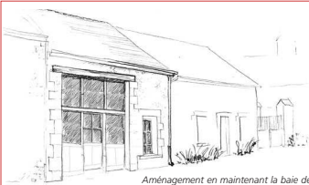
Aménagement en maintenant la baie de la porte de grange. Menuiserie vitrée en proportion avec la baie.
