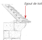
Les égouts de toiture présentent une rupture de pente ici créé par la superposition de tuiles sur la corniche.
